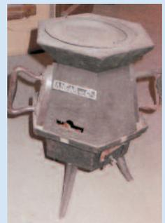
Petit fourneau à bois utilisé en son temps par les repasseuses. Appareil à trois pieds avec, tout autour, une rainure permettant de poser les fers à repasser afin de les chauffer. Six fers pouvaient être chauffés à la fois. Au-dessus du fourneau, une ouverture permettait d'y poser une casserole.
