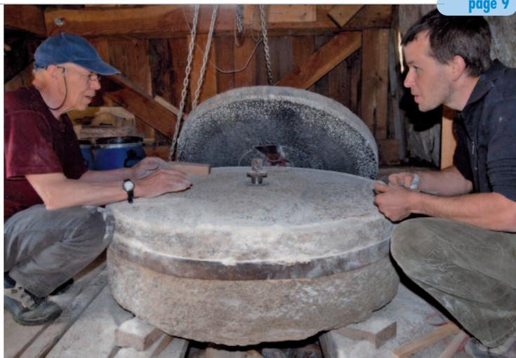
Les meules de pierre sont entraînées par une roue à aubes qui doit être mue par un bisse ou une cascade qui l'alimente par le haut.
